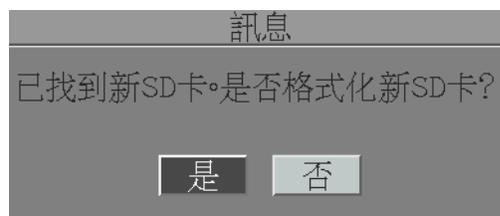
SD 卡安裝完成後，建議您啟用“錄影覆寫”功能，當 SD 卡容量已滿，車用 DVR 可進行 SD 卡錄影覆寫；若此功能未啟用，當 SD 卡容量已滿，警報事件備份錄影將停止，此時車用 DVR 會彈出訊息視窗，告知使用者 SD 卡容量已滿，使用者可換一張新的 SD 卡繼續錄影，或使用慧友 EF Reader 將 SD 卡錄影檔遠端備份後、清除(格式化)SD 卡後繼續錄影。
