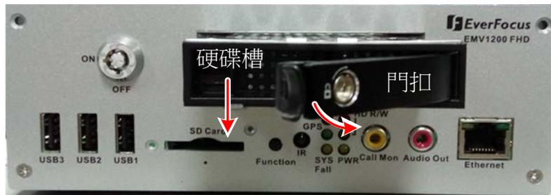
4. 將硬碟放入硬碟槽，並使用隨附的 4 顆硬碟螺絲將硬碟固定至硬碟槽。
