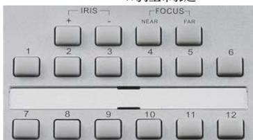
將 EKB200 鍵盤連上 MDVR 且設定 PTZ 控制功能後，請設定上述設定頁面，以定義鍵盤上各控制鍵的功能。按一下 **[儲存]** 按鈕儲存設定值。按下鍵盤的控制鍵後，攝影機即執行所定義的功能。
