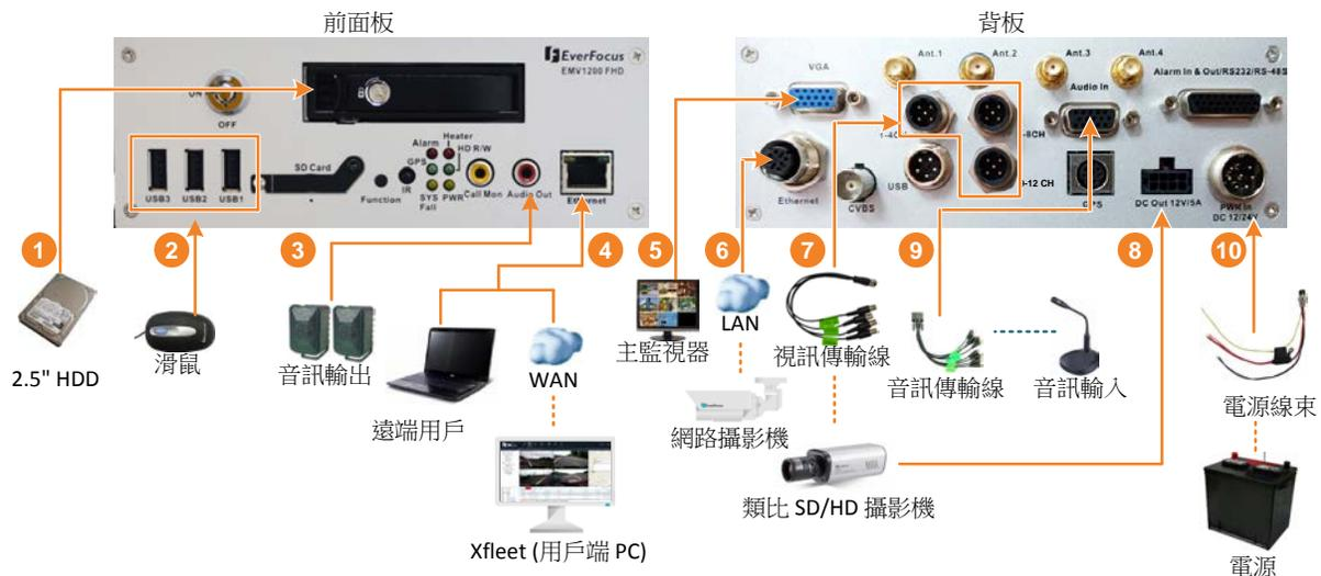
1. 若要錄影，請將 2.5 吋硬碟（或 SSD）插入硬碟槽。插入硬碟後請務必鎖上硬碟槽鎖以及硬碟電源鎖，否則無法開始錄影（請參閱 2.2 安裝硬碟）。
